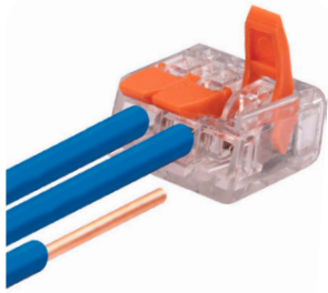
Длина зачистки проводника 10 мм
